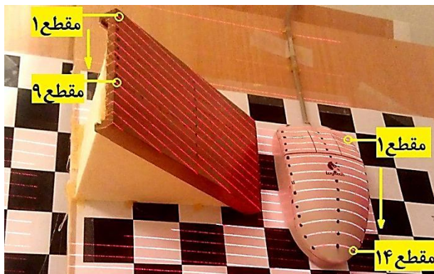
شکل ۸ قطعه کار، سطح شیبدار و مقاطع مورد استفاده جهت شبیه سازی فرایند اعمال نويز
