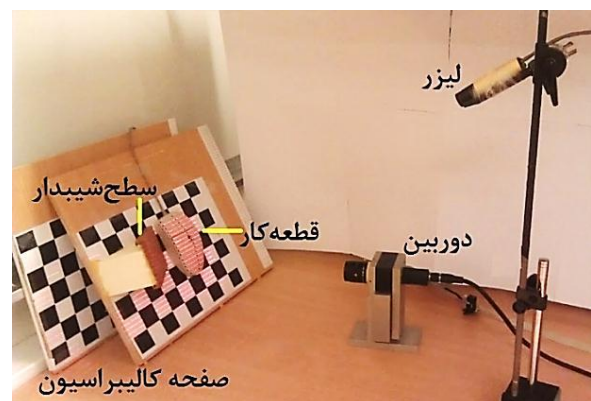
شکل ۷ اجزای سخت افزاری اسکنر ليزري
