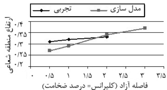
شکل ۵ اثر فاصله آزادبین سنبه و ماتریس بر پهنای منطقه شعاعی (بالا) و ارتفاع منطقه شعاعی (پایین)
