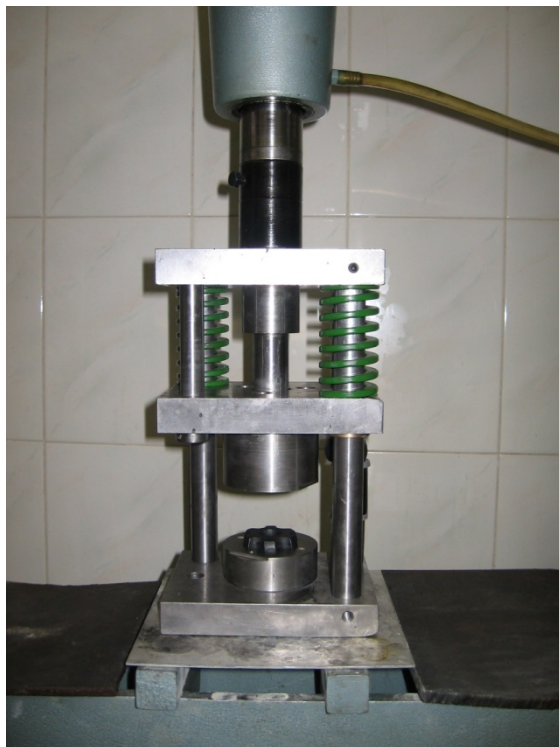
شکل ۲۷ قطعه نهایی داخل حفره قالب پس از تغییر شکل زیر پرس هیدرولیک
