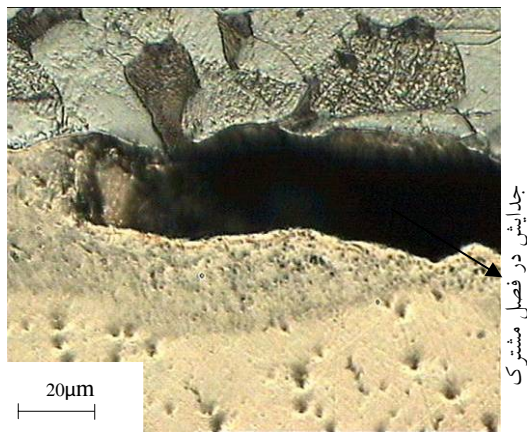
شکل ۱۳ وجود جدایش در فصل مشترک اتصال فولاد و فسفر-برنز، بزرگنمایی ۵۰۰ برابر [۷]
