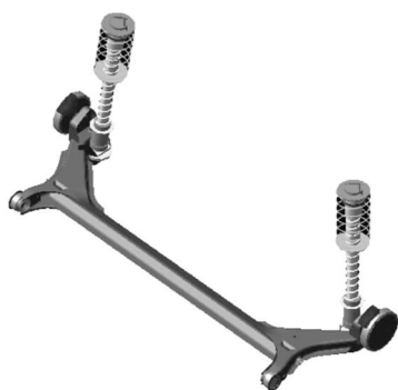
شکل 5 سیستم تعلیق عقب، کامپاوند، شبیه‌سازی شده در نرم‌افزار آدمز
