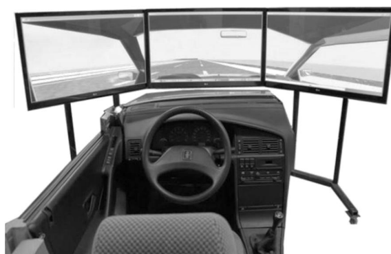
شکل 3 شبیه‌ساز رانندگی سکو ثابت پژو 405
