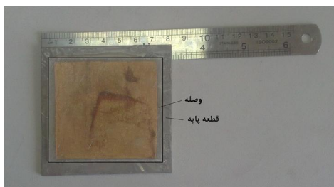
شکل 3 نمونه ترمیم شده آلومینیومی شیاردار
