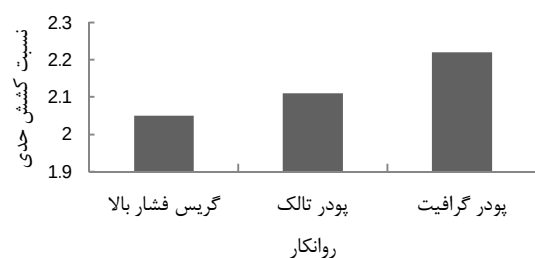
شکل 9 نسبت‌های کشش حدی به دست آمده در دمای 150^{\circ}\text{C}
