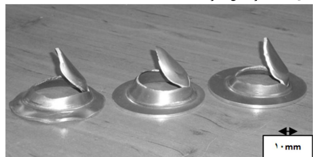
شکل 5 نمونه‌هایی با شعاع گوشه سنبه و شعاع گوشه حفره قالب (mm) به ترتیب از راست به چپ، 4 و 4.4 و 4.6 و 8
