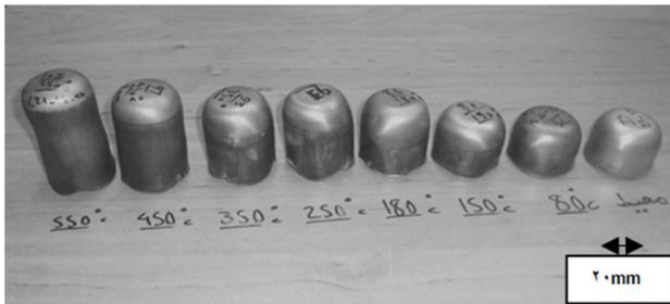
شکل 14 بزرگ‌ترین نمونه‌های شکل گرفته سالم در دماهای مختلف
