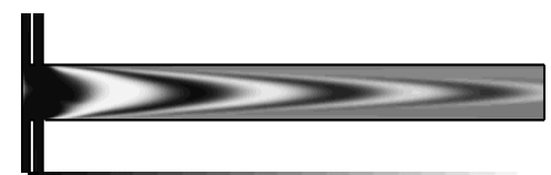
ب- میکرومیکسر با موانع مستطیلی در دیواره کانال اختلاط
