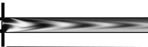
ج- میکرومیکسر با موانع متوازی الاضلاع در دیواره کانال اختلاط
