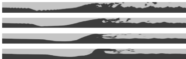
شکل ۲ بررسی استقلال حل از شبکه در راستای ارتفاع کانال (بالا به پایین: ۲۰، ۴۰، ۸۰ و ۱۰۰ شبکه در راستای ارتفاع کانال)
