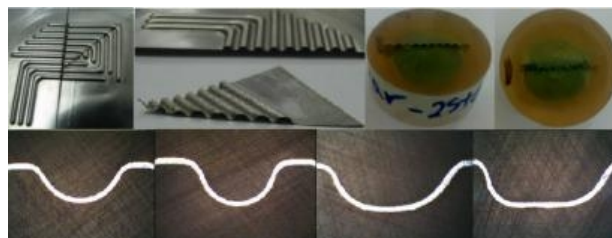
شکل ۱۱ فرایند آماده‌سازی نمونه‌های شکل داده شده به منظور بررسی توزیع ضخامت و درصد پرشدگی پروفیل
