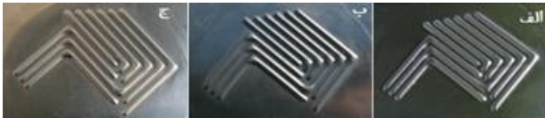
شکل ۹: نمونه های شکل یافته در فشارهای (الف) ۸۰، (ب) ۹۰ و (ج) ۱۰۰ مگاپاسکال
