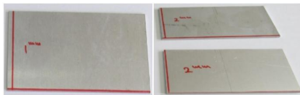
شکل 14 ورق‌های آلومینیم برش داده با وایرکات
