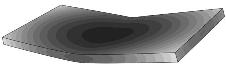
شکل 6 تصویر توزیع دمای ورق در حین فرآیند (الف) 0/36 ثانیه؛ (ب) 1/44 ثانیه؛ (پ) 2/52 ثانیه؛ (ت) 350 ثانیه
