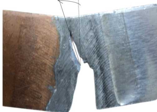
شکل 4 زاویه انتشار ترک در نمونه جوشکاری شده تحت آزمایش خمش چهار نقطه‌ای ( n=80\% )
