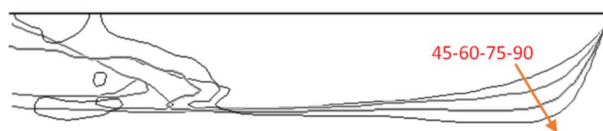
شکل 13 شکل نوک حباب، شیب اول 15 درجه و شیب‌های دوم 45 تا 90 درجه
