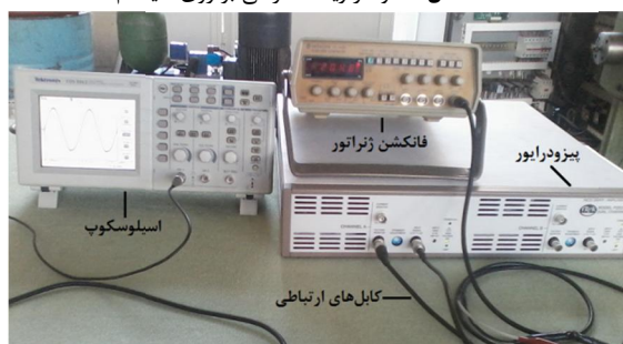
شکل 4 تجهیزات تست و تنظیم فرکانس
