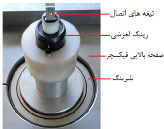
شکل 3 مونتاژ رینگ لغزشی بر روی سیستم
