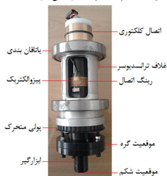
شکل 1 سیستم انتقال ارتعاش اولتراسونیک
