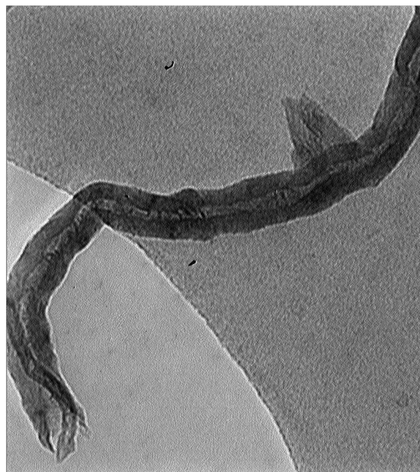
شکل 4 تصویر میکروسکوپ الکترونی عبوری (TEM) سوسپانسیون آبی نانولوله‌های کربنی چند جداره
