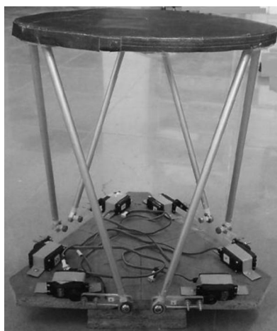
شکل 7 نمایی از سکوی استوارت ساخته شده
