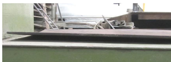
شکل 7 وضعیت توزیع خمیدگی در طول ورق
