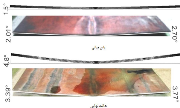
شکل 20 مقایسه نتایج عددی و تجربی برای زاویه خم در ورق ضخامت 8 میلی‌متر
