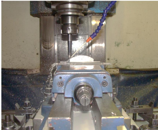
شکل 4 چیدمان انجام آزمایش به‌همراه قطعه‌کار در فرزکاری
