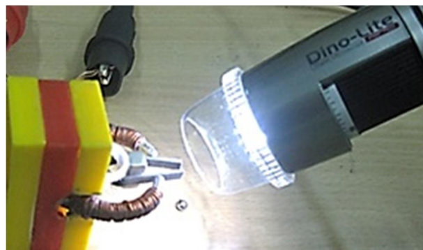
شکل 14 اندازه گیری میکروسکوپی زاویه انحنا تیرهای فک گریپر مینیاتوری
