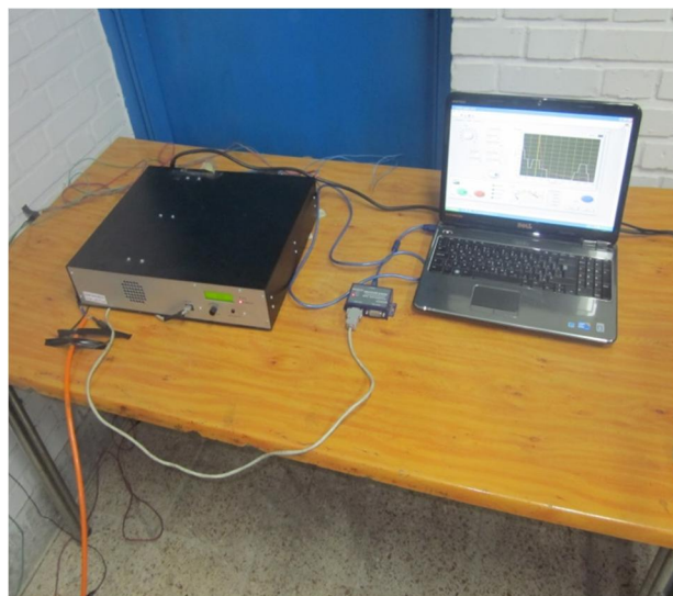
شکل 12 ژنراتور استفاده شده در این تحقیق برای به دست آوردن فرکانس تشدید
