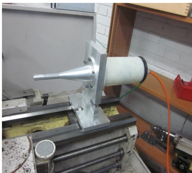
شکل 11 ابزار ارتعاشی ساخته شده و نحوه گیره بندی ابزار ارتعاشی
