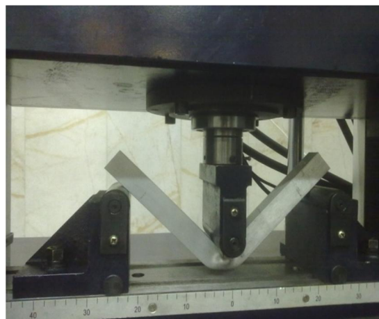
شکل 3 شمایی از روش بارگذاری لوله در آزمایش‌خمش سه نقطه‌ای لوله آلومینیومی مربعی
