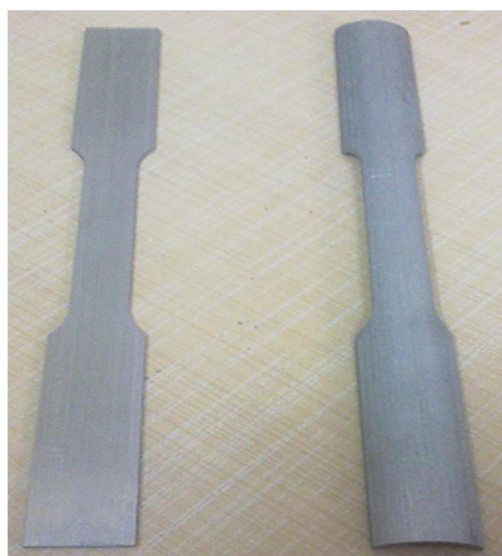
شکل 1 نمونه دمبلی شکل برای تست کشش
