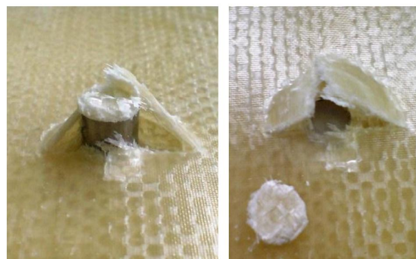
شکل ۹ تأثیر نفوذ کننده سرتخت بر ورق کامپوزیتی
