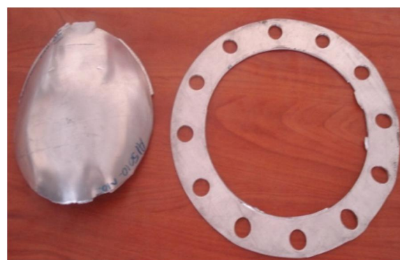
شکل 9 حالت واماندگی II (پارگی کامل از تکیه‌گاه)
