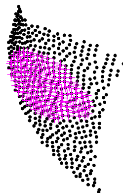
شکل 13 الف- دو ابر نقاط قبل از هم‌مرجع‌سازی ب- ابرهای نقاط بعد از
