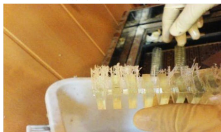
شکل 7 جداکردن تکیه‌گاه از قطعه‌کار
