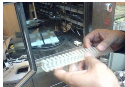
شکل 8 قرار دادن نمونه‌ها در حمام التراسونیک جهت پخت نهایی
