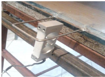
شکل 2 نحوه قرار گیری لودسل
