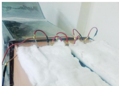
شکل 3 سطح شار ثابت با عایق پشم سنگ
