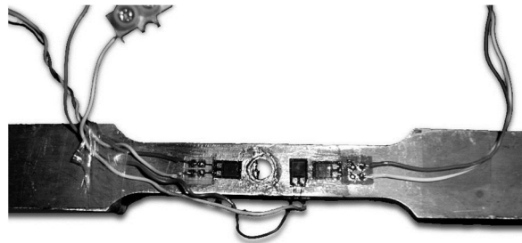
شکل 1 نصب سه کرنش سنج بر روی نمونه اول
