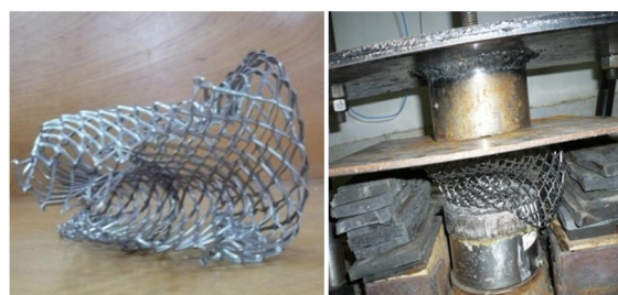
شکل 15 فروریزش نمونه مشبک 1-1 با زاویه سلول \alpha=90
