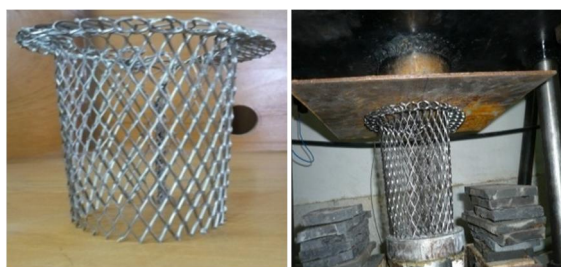
شکل 18 فروریزش نمونه مشبک 4-4 با زاویه سلول \alpha=90
