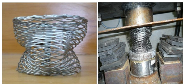
شکل 8 فروریزش نمونه مشبک 2 با زاویه سلول \alpha=0
