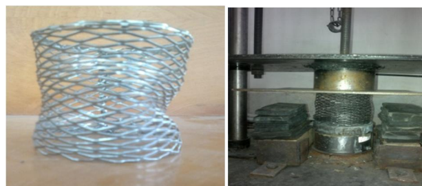
شکل 7 فروریزش نمونه مشبک 1 با زاویه سلول \alpha=0
