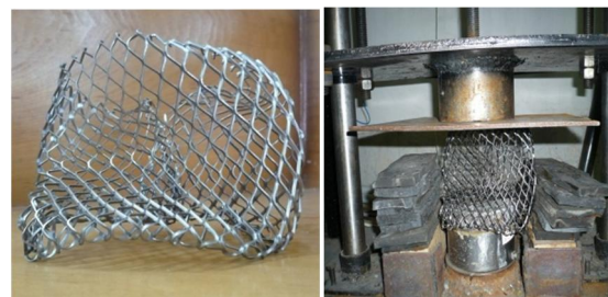
شکل 16 فروریزش نمونه مشبک 2-2 با زاویه سلول \alpha=90
