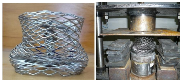
شکل 9 فروریزش نمونه مشبک 3 با زاویه سلول \alpha=0
