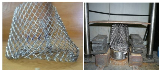
شکل 17 فروریزش نمونه مشبک 3-3 با زاویه سلول \alpha=90
