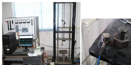
شکل 3 شماتیک دستگاه سقوط وزنه و سنسور شتاب سنج
