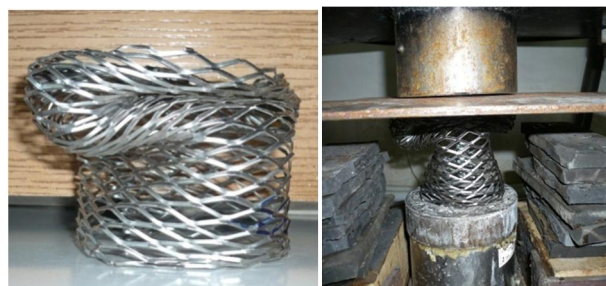
شکل 10 فروریزش نمونه مشبک 4 با زاویه سلول \alpha=0
