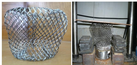
شکل 19 فروریزش نمونه مشبک 5-5 با زاویه سلول \alpha=90
