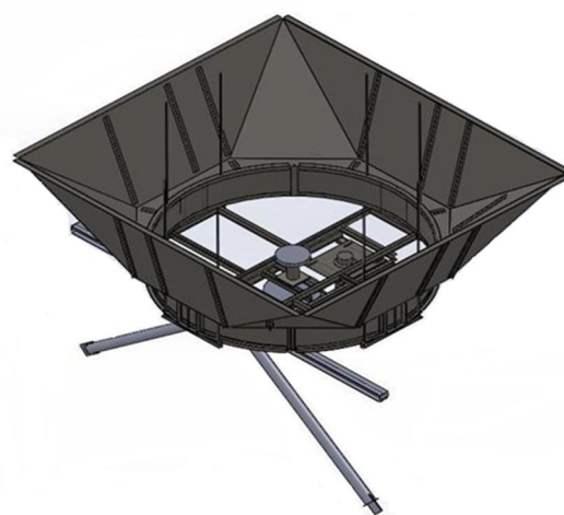
شکل 7 کانال هوایی به همراه سازه فن
