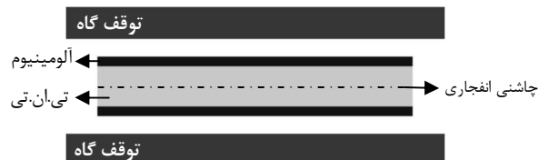
شکل 4 شماتیک چیدمان آزمایش استوانه و مکان مربوط به نقاط دتونیشن به همراه نمودار مربوط به شرایط مرزی مورد استفاده در تحقیق
