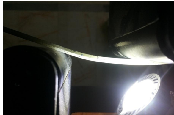
شکل 6 تعیین محل نوک ترک با روش نورپردازی
