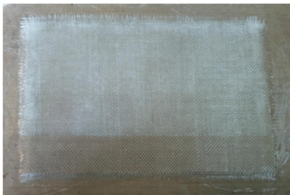
شکل 1 نمونه نانوکامپوزیتی در حال ساخت دارای ترک اولیه تفلونی
