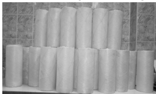
شکل 1 پوسته‌های مشبک نانوکامپوزیتی تولید شده به روش پیچش لایاف
