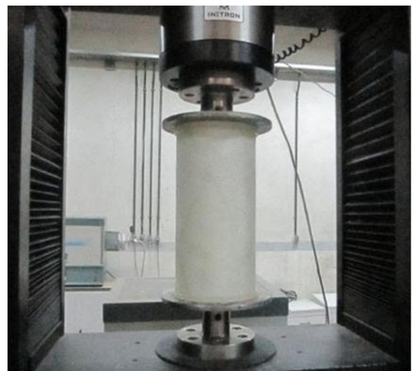
شکل ۷ پوسته مشبک نانوکامپوزیتی تحت بار محوری فشاری
