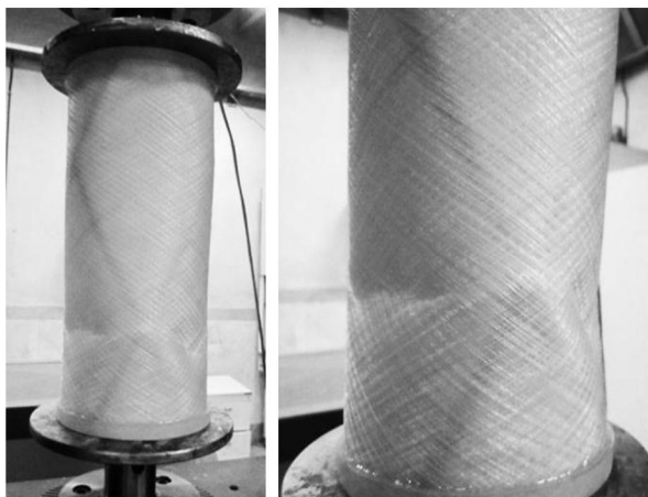
شکل ۸ پوسته‌های مشبک نانوکامپوزیتی پس از کمانش.
