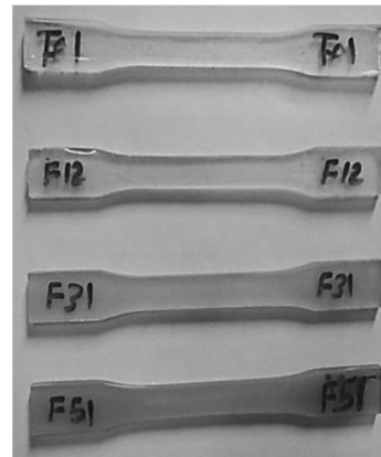
شکل 4 نمونه‌های نانوکامپوزیتی ساخته شده جهت انجام آزمون کشش تک محوری
