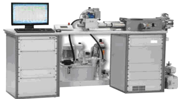
شکل 1 دستگاه دیلاتومتری استفاده شده در این تحقیق [20]
