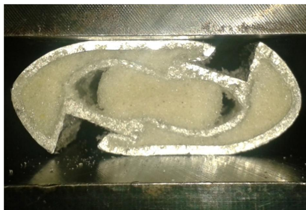
شکل 14 نمونه جدار نازک پر شده از فوم تحت بارگذاری با زاویه 45 درجه، در حین فرایند پهن‌شدگی جانبی
