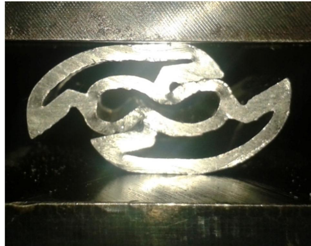
شکل 17 نمونه جدار نازک توخالی تحت بارگذاری با زاویه 60 درجه، در حین فرآیند پهن‌شدگی جانبی
