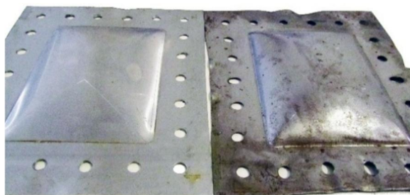
شکل 4 نمونه‌هایی از تغییر شکل ورق مستطیلی تحت بارگذاری هیدرودینامیکی
