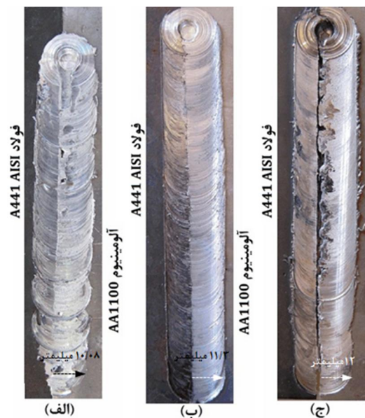
شکل 10 نمونه‌های جوشکاری شده در سرعت دورانی 500 دور در دقیقه و افست (الف) 0/8، (ب) 1/3 و (ج) 2 میلی‌متر در درون آلومینیوم
