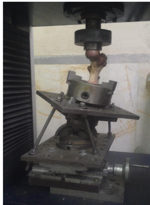
شکل 3 نمونه استخوان ران مفید شده در فیکسچر و تحت شرایط بارگذاری در دستگاه تست کشش-فشار
