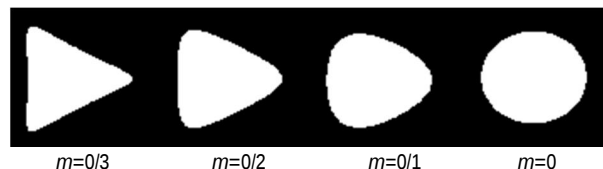
شکل 3 تأثیر پارامتر m بر گوشه‌های گشودگی مثلثی
