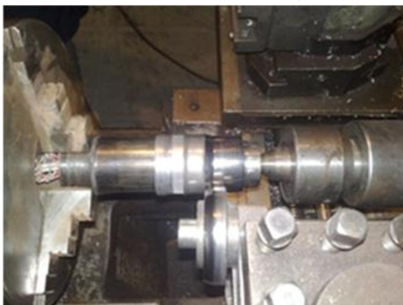
شکل 1 نحوه انجام فرآیند فلوفرمینگ
