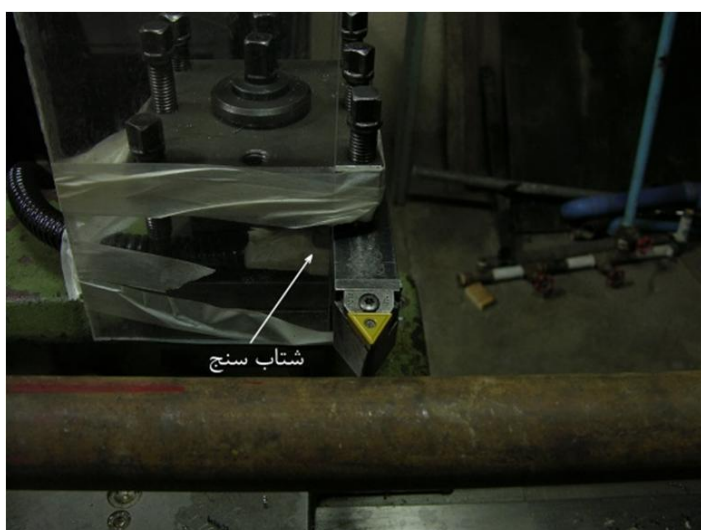
شکل 1 تنظیمات و محل قرارگیری شتاب‌سنج در آزمایش‌ها
