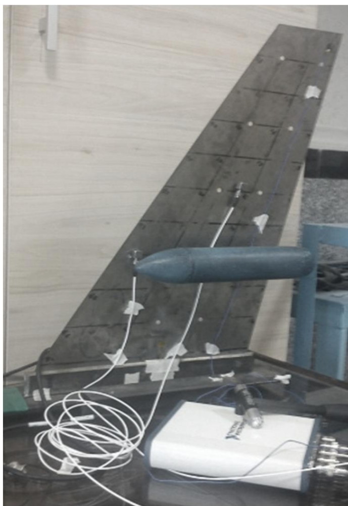
شکل 6 تجهیزات و نحوه انجام آنالیز مودال
