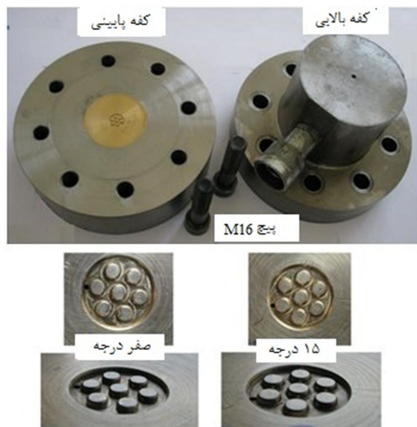
شکل 4 مجموعه قالب به منظور شکل دهی پین های تکرار شونده با الگوی پینی
