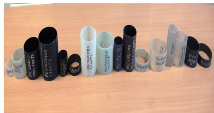
شکل 2 پوسته‌های استوانه‌ای کامپوزیتی پس از ساخت و برش
