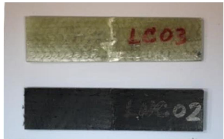
شکل 18 نمونه‌های خمشی پس از آزمایش
