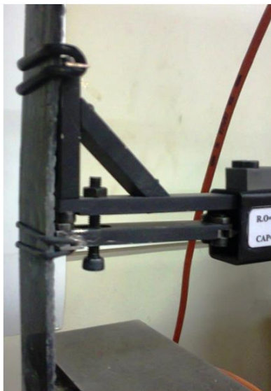
شکل 7 یک نمونه از آزمایش کشش
