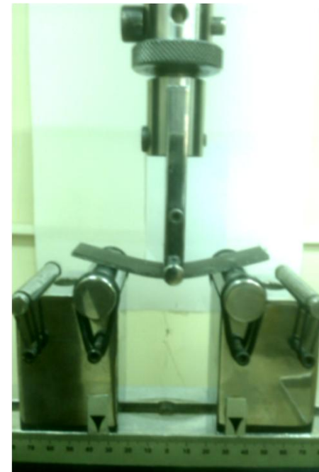
شکل 8 یک نمونه از آزمایش خمش سه نقطه
