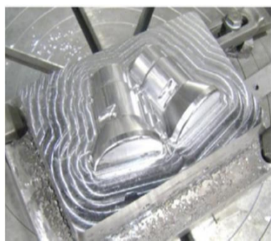
شکل 3 ساخت قالب به همراه سیستم خنک کاری [5]
