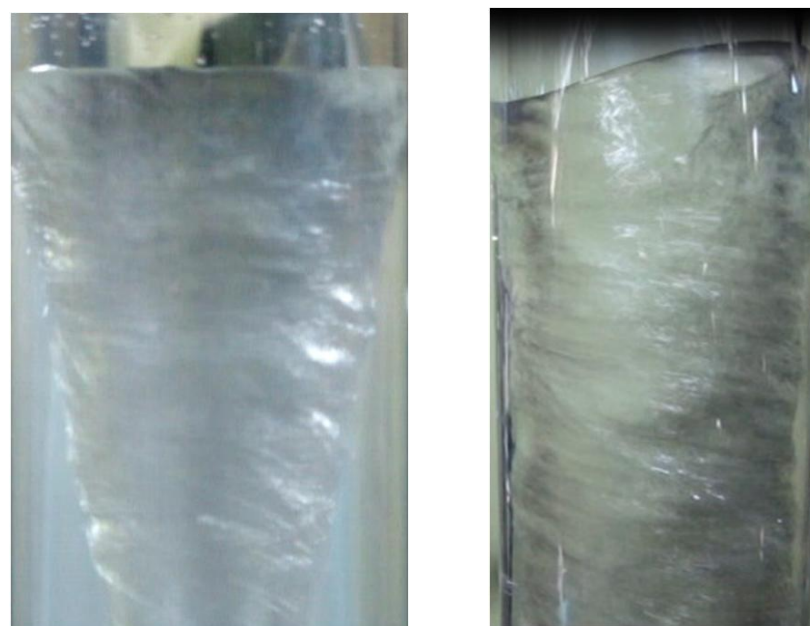
شکل 12 تاثیر قطر محفظه بر یکنواختی جریان گردابه‌ای
