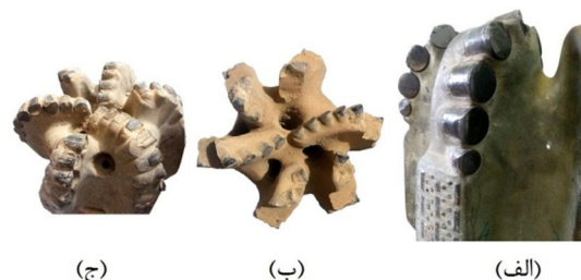
شکل 21 خرابی مته‌ها پس از عملیات حفاری
