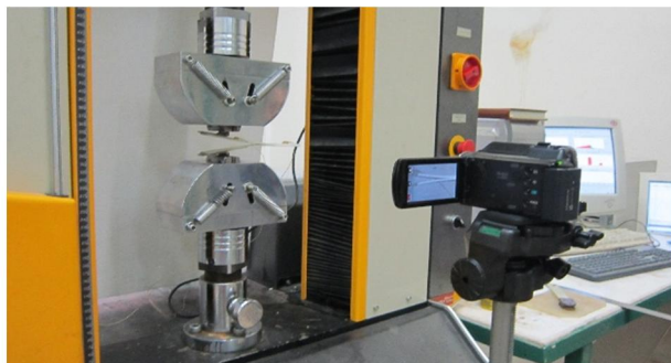
شکل 2 آزمون شبه استاتیکی رشد جدایش بین لایه‌ای، تحت بارگذاری مود I
