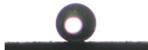
الف) نمونه 2 با زاویه تماسی حدود 161 درجه
