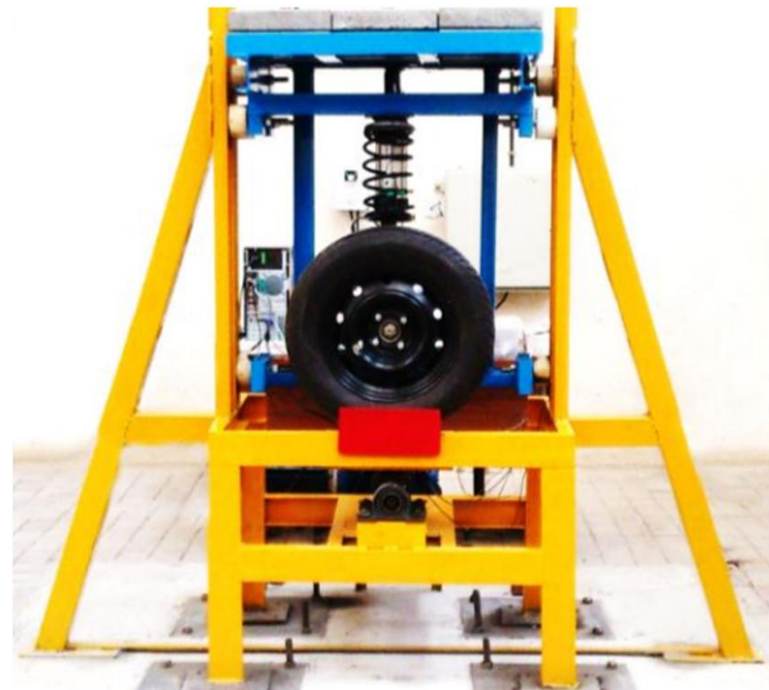
شکل 1 دستگاه آزمایش یک چهارم سیستم تعلیق ساخته شده
